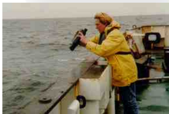
Les analyses de la couleur de l'eau sont effectuées en mer au moyen d'un spectroradiomètre manuel
