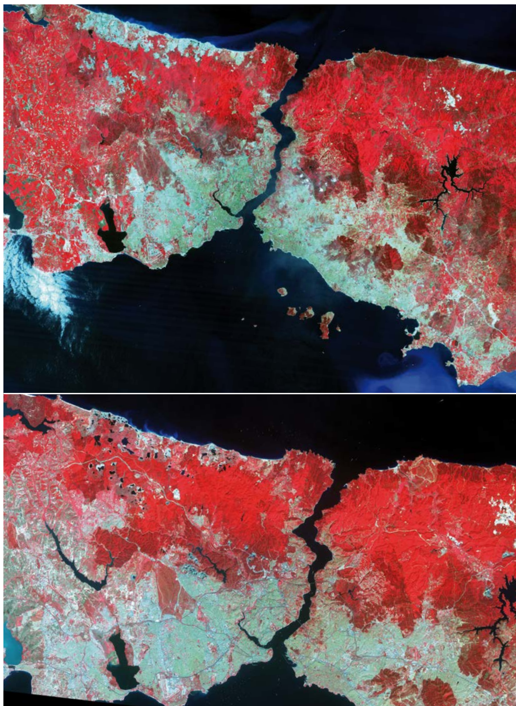
Satellietbeelden van Istanbul in 1990 (bovenaan: Landsat 5-beeld met een resolutie van 30 m) en 2009 (onderaan: SPOT 5-beeld met een resolutie van 10 m). Op deze valsekleurenbeelden is de stadsuitbreiding goed zichtbaar in grijsgroen.
