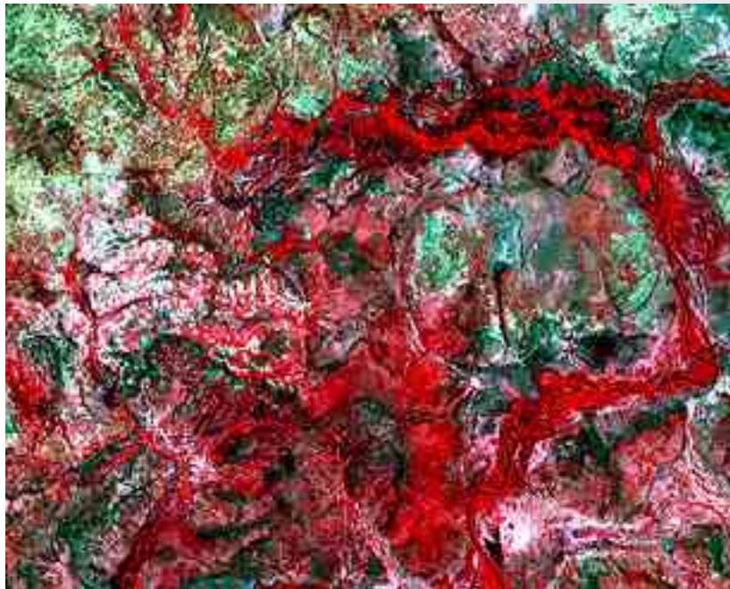
Une combinaison fausses-couleurs (bandes 2, 3 et 4 d'une image TM) © ESA, distributed by Eurimage
