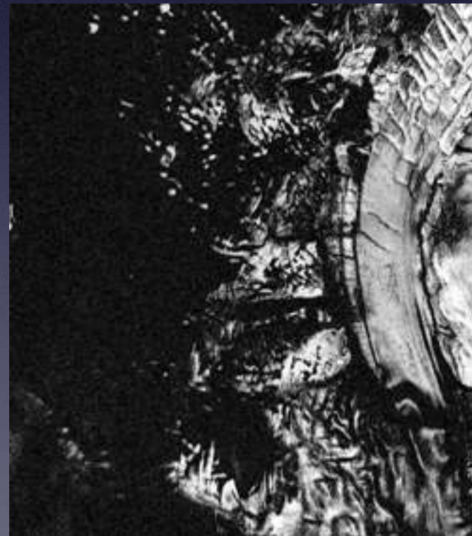
Interferometric coherence before and after tracking ERS Tandem 2-3 juin 1996
