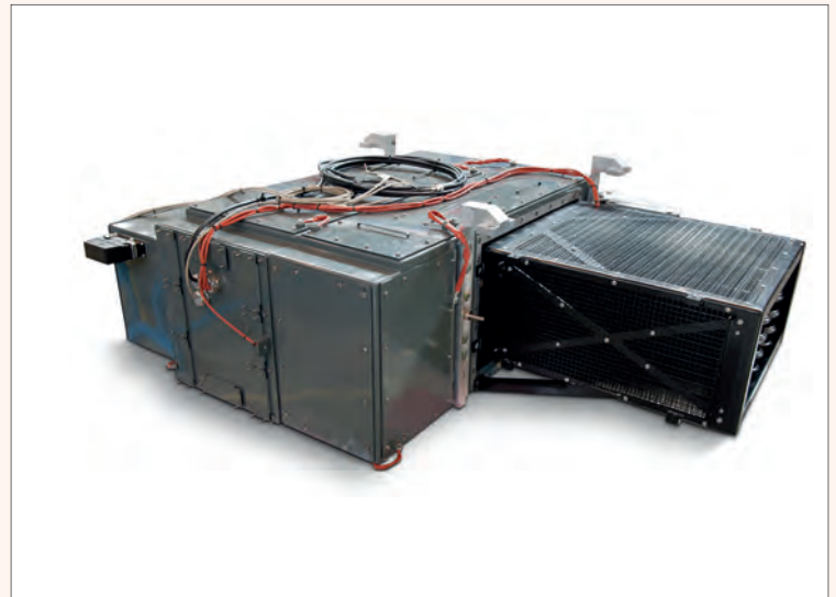
Systeem voor warmteafvoer voor een trein. © Calyos SA - M. Bries, Mandragore
