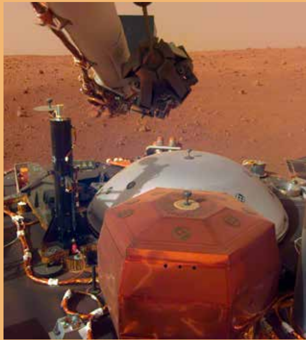
Photo des instruments SEIS et HP 3 sur la plateforme, avant leur déploiement, sur fond de paysage martien. © NASA/JPL-Caltech
