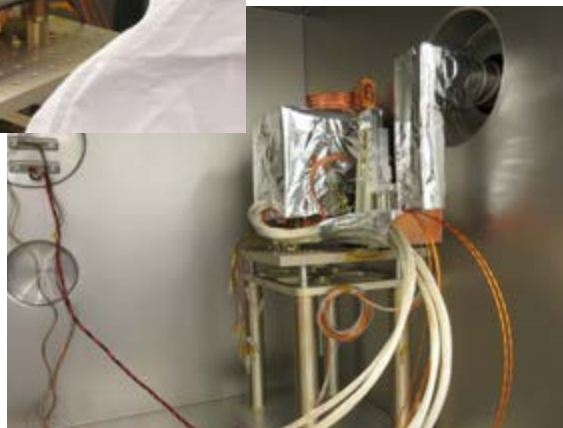
Figure 6. Le détecteur MAJIS VIS-NIR lors de son intégration dans la chambre à vide pour la campagne de caractérisation.
