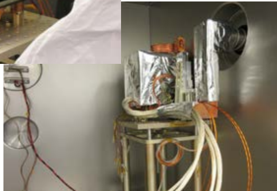
Figuur 6: De MAJIS VIS-NIR-detector tijdens de integratie in de vacuümkamer voor de karakteriseringscampagne.
