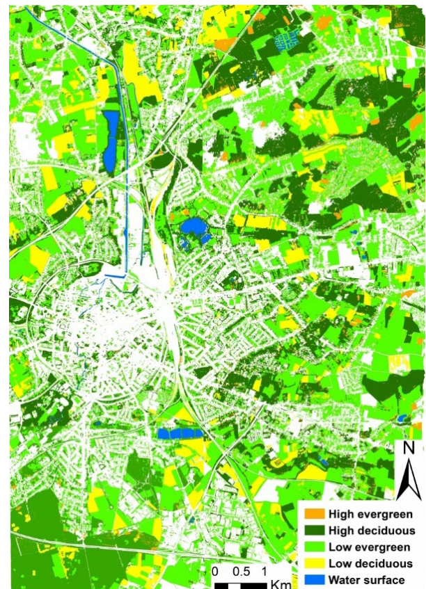
Carte des surfaces végétalisées de Leuven en 2015 obtenue grâce à une classification orientée objets (OBIA) à partir d'images Pléiades et d'images saisonnières SPOT.
